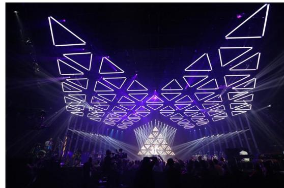
Kinetic Tube Light es un nuevo tipo de equipo de escenario que hace que el evento sea más emocionante. Puede subir y bajar mediante el controlador DMX, la velocidad se puede seleccionar y el color se puede controlar mediante el controlador DMX.
